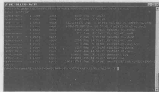
图 9.3 实际上虚拟机的每一个虚拟硬盘都对应 2 个不同的 VMDK 文件, 但是 vSphere Web 客户端只显示了其中一个文件
