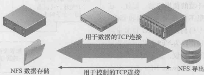
图 6.48 每一个 NFS 数据存储有两个连接 NFS 服务器的 TCP 连接,但是只有一条用于传输数据
