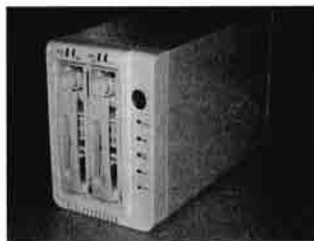
▲ RAID 的目的是将多台硬盘组合成一个大的存储池
