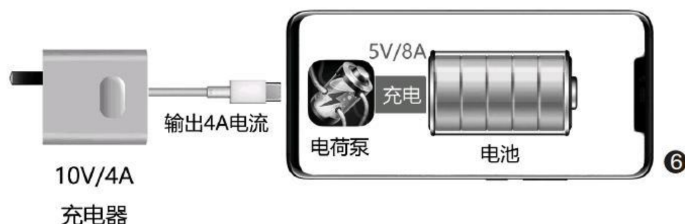
华为40W超级快充电荷泵原理示意图
