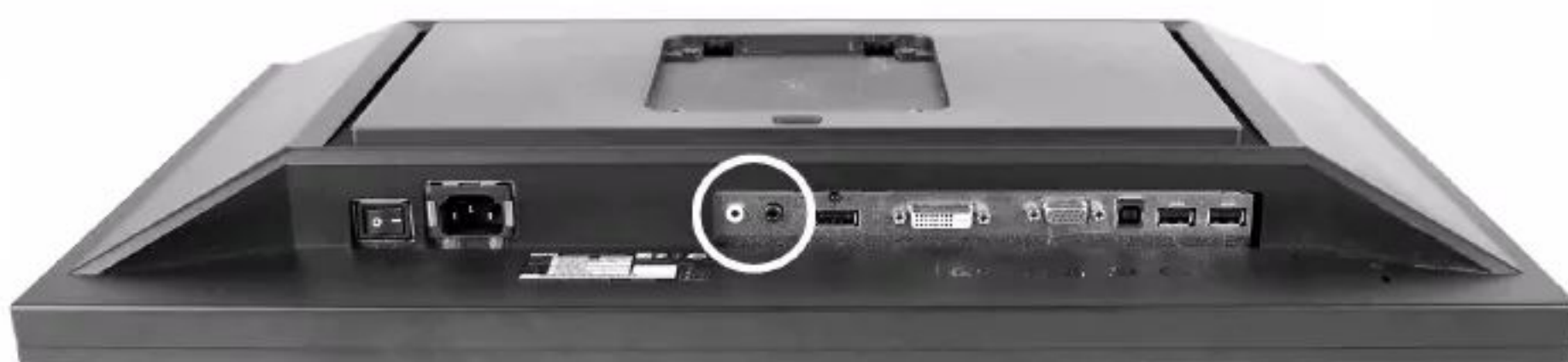
② • 带有音箱的显示器通常也带有标准音频输入输出接口（圆圈中）
