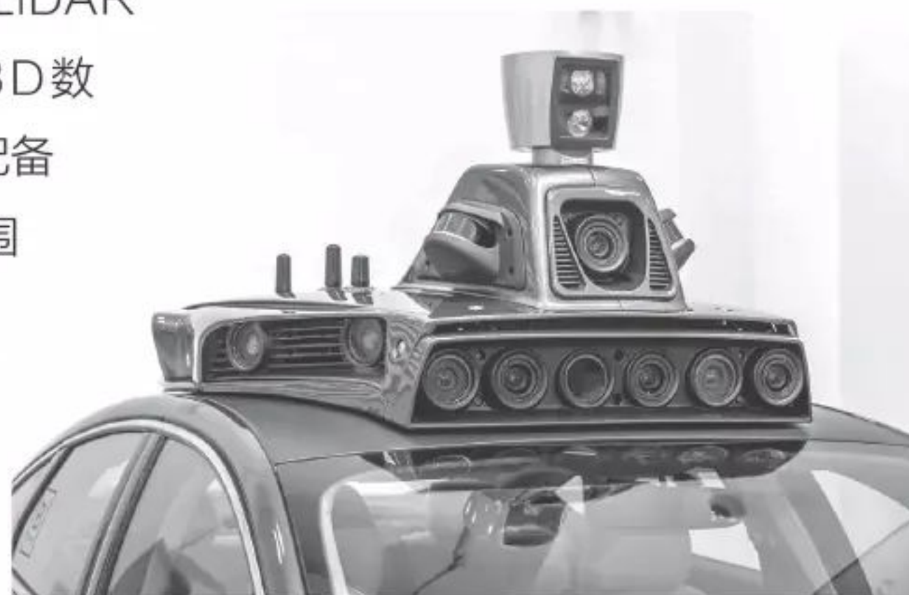
③ • 自动驾驶汽车配备的多个3D LiDAR传感器
