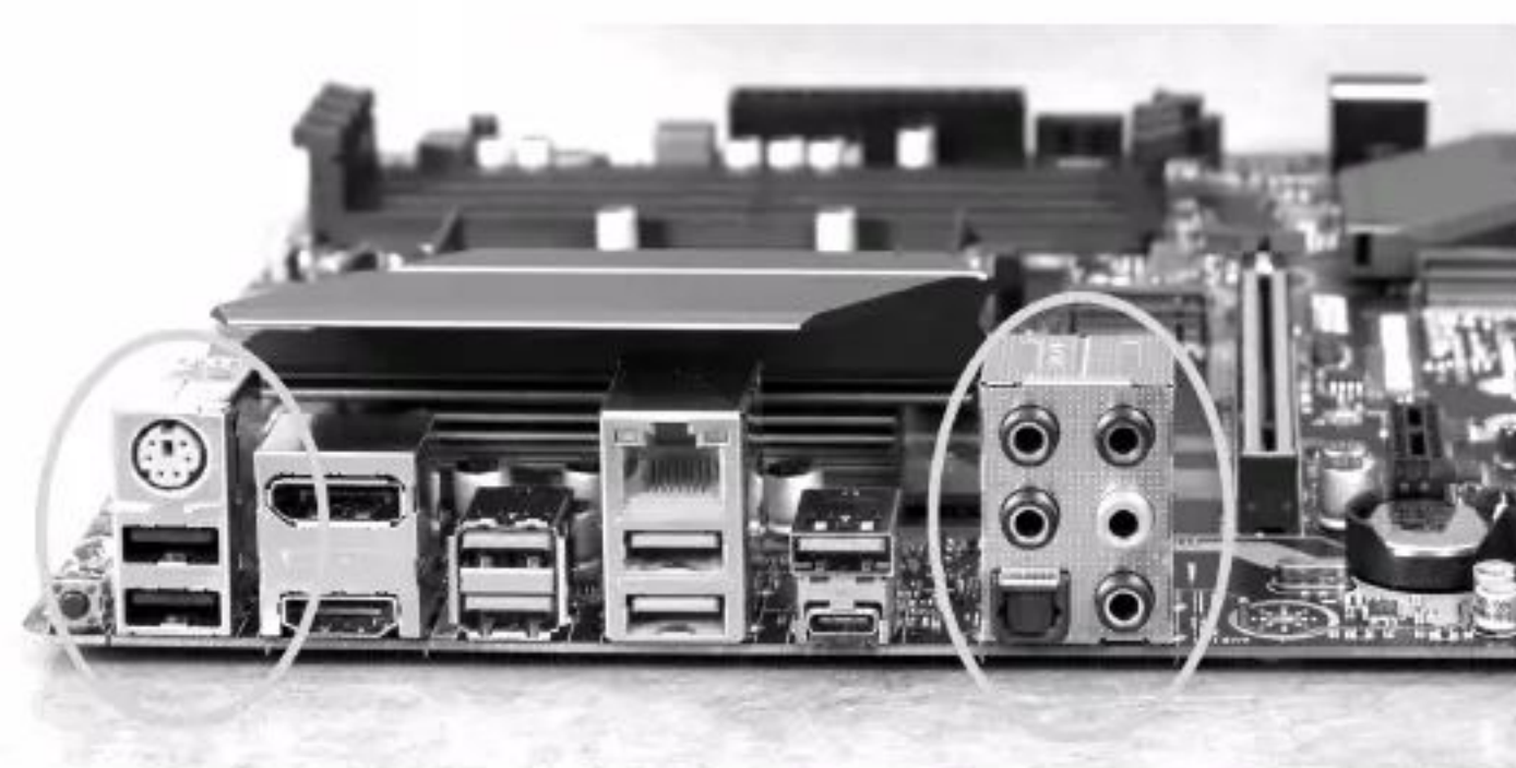
① • 某款电竞主板提供的键鼠专用接口（左圈内）和镀金音频接口（右圈内）
