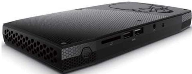
这款产品需要用户自行安装内存和硬盘，它提供了两个笔记本DDR4内存插槽以及两个M.2固态硬盘插槽，支持2280和2242两种规格的M.2固态硬盘。其他如USB接口、视频输出接口等配置都采用了较新的标准，数量也基本够用，扩展能力不错。
