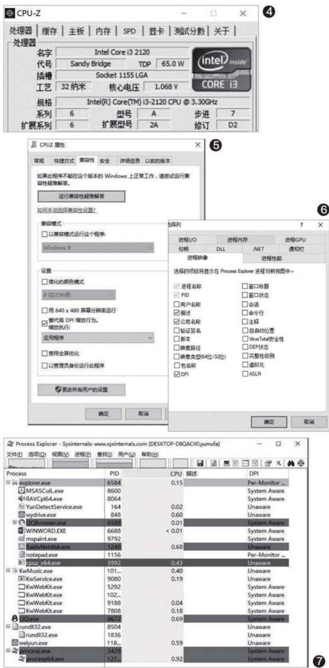
那么如何判断程序是否完美支持系统DPI缩放？可以借助ProcessExplorer软件查看。启动程序后点击“视图→选择显示的项目”，在打开的窗口勾选“DPI”（图6）。这样，对于所有正在运行的程序，如果在DPI选项下显示为Unaware则表示不支持，System Aware是支持，Per-Monitor Aware则是支持多显示器动态自适应。对于不支持的程序如上述介绍的CPU-Z，则可以使用替代DPI缩放行为进行定向优化了（图7）。**CF**
