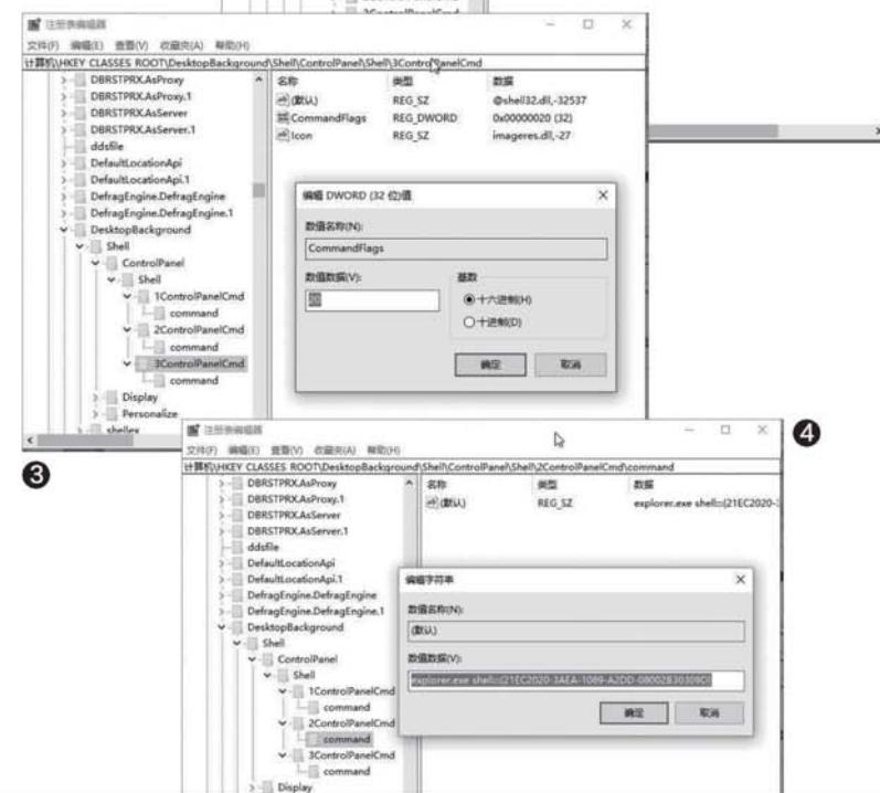
接下来，在三项ControlPanelCmd下，各自分别新建command子项（图4），数据分别设置为：
