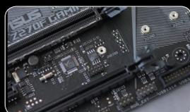
● 超长规格SSD支撑位以及TPU芯片
