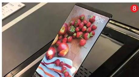
物材料（荧光粉，如果用白色有机材料还需在TFT表面增加三原色彩色滤光膜），从而形成密集的独立发光的OLED灯珠阵列（图5）。由于OLED等同于像素且无需额外的灯管或灯条光源就能显示，所以叫做自发光。
