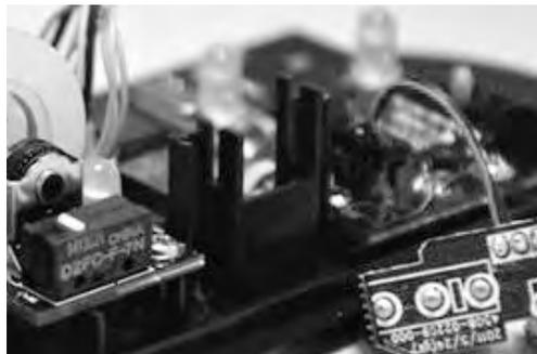
片过脆则需要更换新的滚轮坐标编码器。如果鼠标是光栅式滚轮的话，只能拿去维修或者是换新，目前市面上缺少更换光栅式滚轮的零部件。
