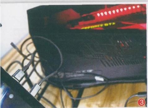
以华硕早期的 XG Station为例，它采用了 ExpressCard插槽 (PCI-E x1) 与笔记本相连接，可惜 ExpressCard插槽的传输速率太低，通过它安装的台式显卡会出现40%甚至更高的性能损耗。
