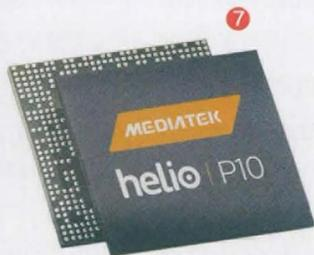
了联发科Helio P10处理器(图7),有些型号的主频为2.0GHz,有些型号的主频却仅有1.8GHz。于是,两类手机之间的性能同样出现了差距。和高通不同的是,联发科给不同主频的Helio P10都起了一个对应的名字,2.0GHz版叫MT6755,而1.8GHz版本则为MT6755M。只是,有些手机厂商会故意淡化MT6755M,只以它的家族名称Helio P10加以宣传,所以才会出现频率上的纠纷。
