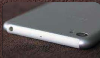
● S90顶部塑料区域集成了WIFI、GPS、蓝牙、LTE低频四种功能的天线
