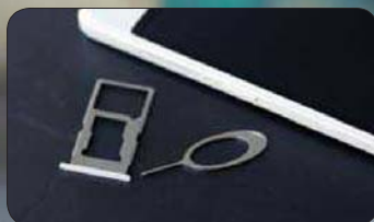
● 双SIM卡托，其中microSIM卡位还可加装存储卡
