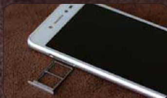
● S90的SIM卡槽可同时加装两个SIM卡，支持移动4G网络
