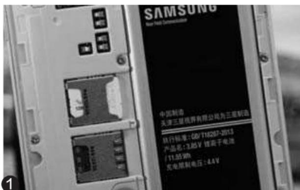
1 • Note4拆开盖即可更换电池或安装存储卡
