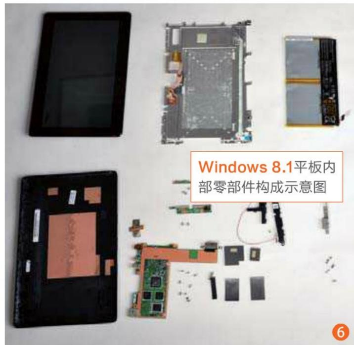
Windows 8.1平板内部零部件构成示意图
