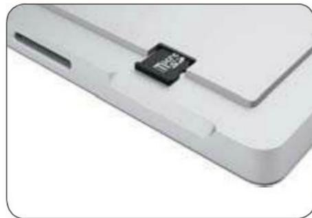
● 隐藏在支架后面的存储卡插槽
