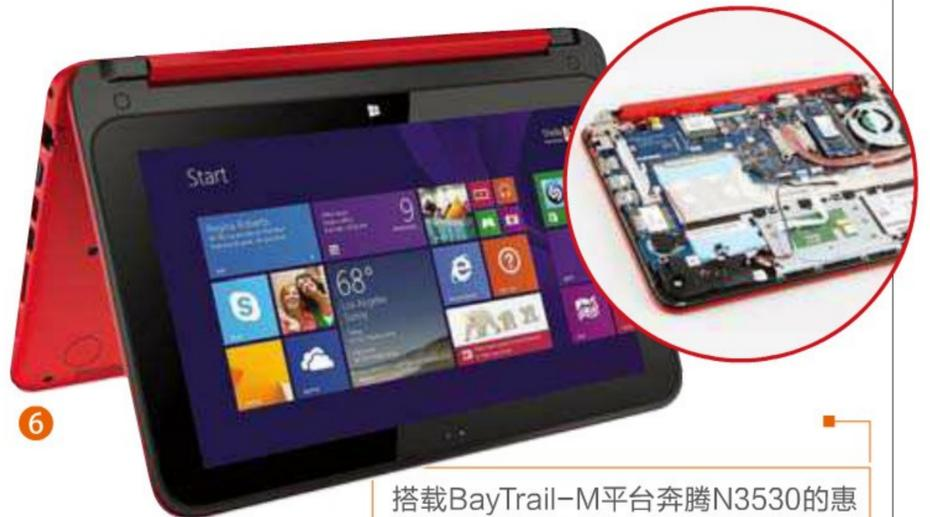
搭载BayTrail-M平台奔腾N3530的惠普X360，由于BayTrail-M的发热高于BayTrail-T，内部必须配风扇辅助散热
