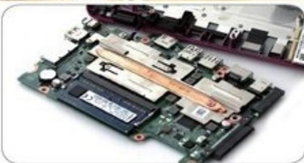
● 简单至极的无风扇散热模块
