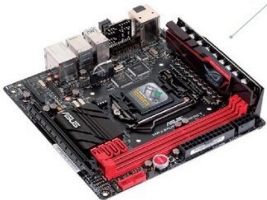
华硕ROG系列的ITX主板一直是迷你主板领域最强的产品，应对Z97华硕推出了新一代的Maximus VII Impact主板，简称M7I。主板供电VRM采用外置垂直安装的8+2相数字供电，使用了日系厂商的10K黑金电容。
