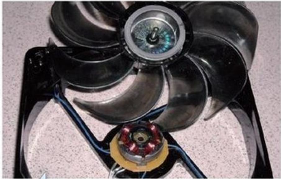
长时间高温运行会加速油封风扇老化
