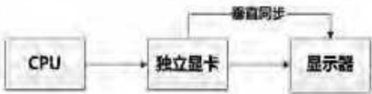
> 传统垂直同步的流程图
