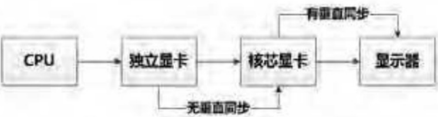
> Virtual Vsync流程图
