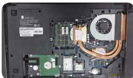
● 处理器和GPU使用不同的热管散热效果出色
