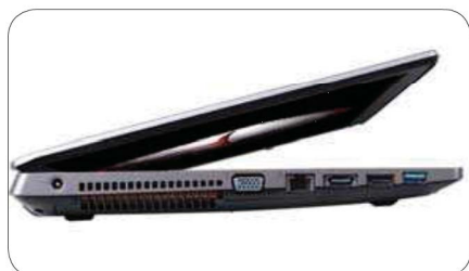
● 左侧两个USB接口(e-SATA)通过HDMI隔开
