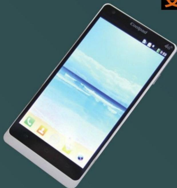
酷派8920智能手机配备5.0英寸视网膜屏,采用了1.7GHz高通MSM8960处理器、Android 4.1系统,是国内首款支持“五模十频”的4G手机,该机支持TDD-LTE、FDD-LTE两种4G协议,以及TD-SCDMA和WCDMA两种3G通讯协议。在4G网络中,理论下载速度高达100M/s。
