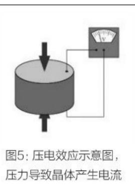
图5：压电效应示意图，压力导致晶体产生电流
