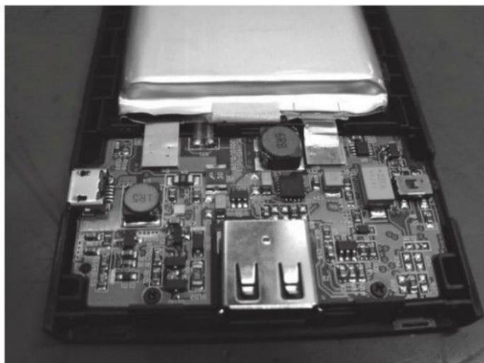
某品牌移动电源拆解图（上方白色部分为电池，下方为电路板）
