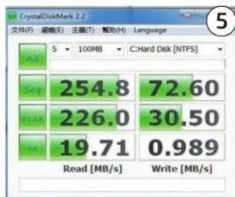
之后，读取速度已经提高到了254.8MB/s（图5），几乎达到了纯SSD固态硬盘的水准！同时我们也不难发现，缓存硬盘对机械硬盘的写入速度几乎没有任何提升，但这并不重要，因为影响开机、程序加载和系统反应的关键就是读取速度。
