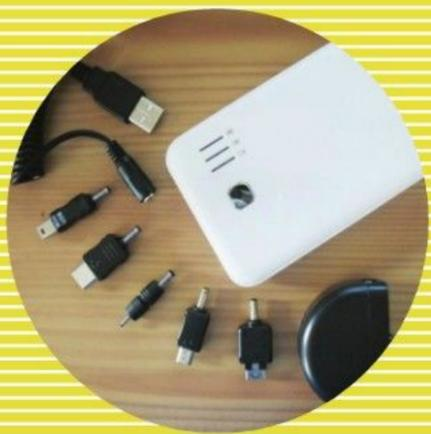
配备不同的接头移动电源可以为不同的设备充电
