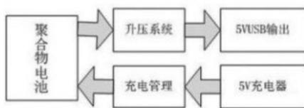
图1: 移动电源结构示意图
