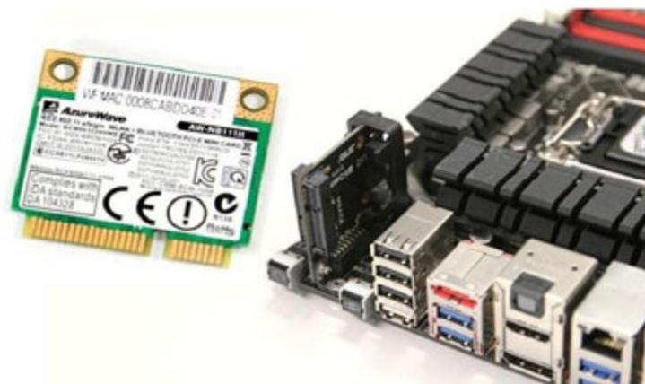
另外一个功能就是网络，这里实现了mPCIe Combo功能，整合Wi-Fi和蓝牙4.0于一身。mPCIe囊括PCI Express 2.0与USB 2.0总线，使用主板附送的AzureWave无线扩展卡（博通BCM943228HMB），就能支持2.4/5GHz双频段Wi-Fi 802.11a/b/g/n及蓝牙。需要注意的是，mPCIe插槽仅支持半高26.8mm×30mm的mPCIe模组设备。
