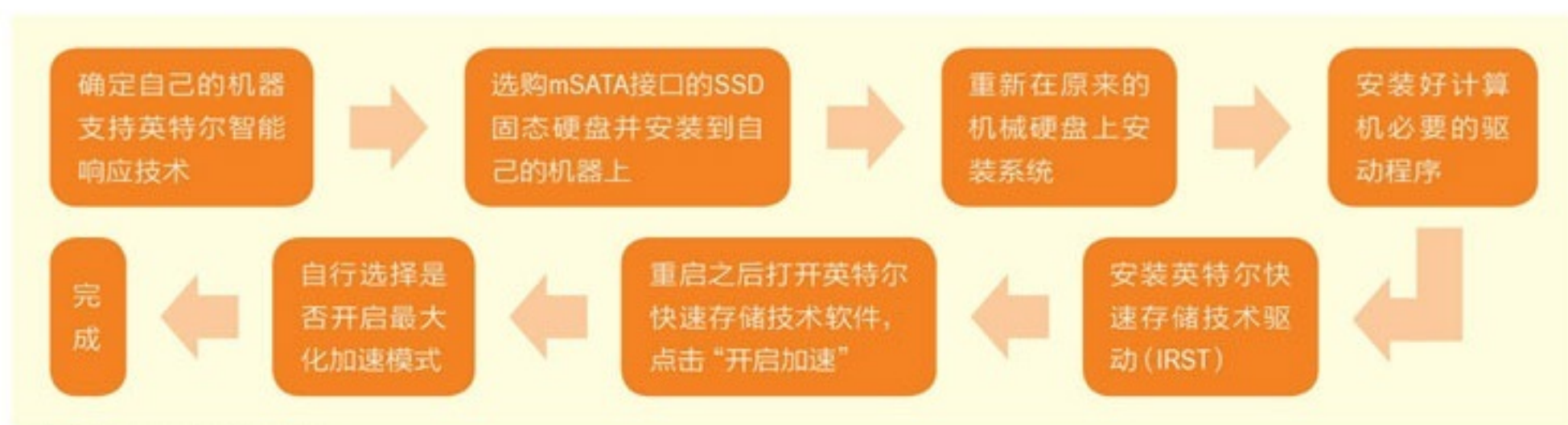
开启英特尔智能响应技术流程图
