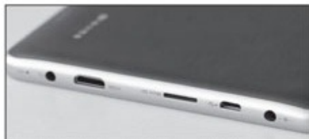
烈焰采用了MicroUSB接口，并提供HDMI输出接口
