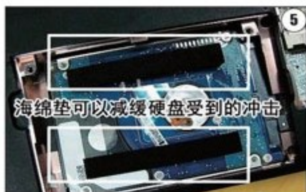
海绵垫可以减缓硬盘受到的冲击
