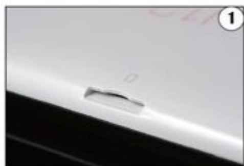
↑平板电脑上的SIM卡插槽，需关机时插入
