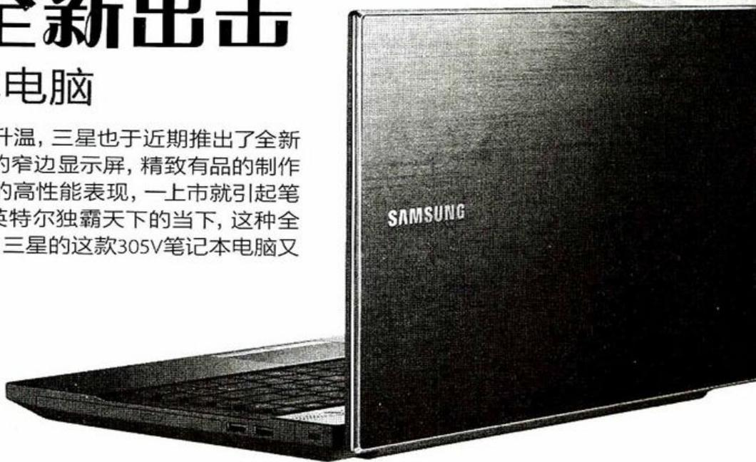
4核。得益于“异构计算”的优势,APU功耗控制非常到位,进而使得三星305V可轻松获得较长续航能力。三星305V支持AMD Turbo Core智能超频技术,在应用要求非常高的情况下,可以通过AMD智能超频技术使频率提升高达700MHz,等同于44%。这里给大家举例说明一下:
