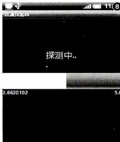
度条到100%表示探测到金属,此时会振动或者声音提示。由于是利用电磁感应进行工作,这里提醒大家,探测金属的时候一定要来回移动“探测仪”,让探测仪切割磁力线,避免探测不到金属。在使用中探测仪可能出现误报,常见的原因是探测仪灵敏度设置过高引起。单击菜单键,选择“设置”->“设置灵敏度”,系统默认为5,9为最高,建议大家选择为8。
