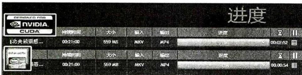
核心显卡的“Quick Sync Video”技术很实用，将一部720P（559MB，21分钟左右）的视频转换为iPhone 3GS播放的H.264编码，640×360像素的MP4格式视频只用54s，而用NVIDIA GT540M独显却需要172s！
