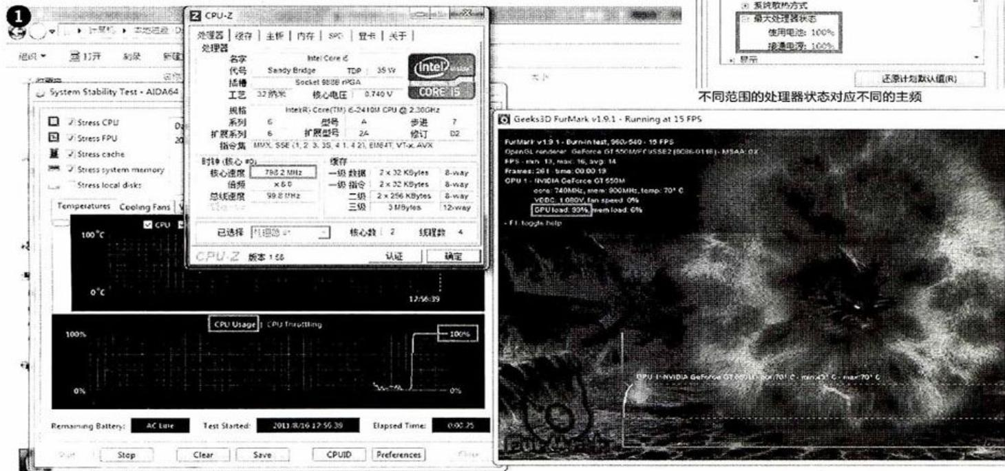
运行Geeks3d显卡负载烘烤软件FurMark时，当CPU和GPU都达到满负载状态时，i5-2410M并没有出现睿频加速，而主频还被自动降到了798MHz，卡顿是必然的
