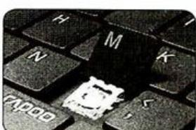
剪刀脚悬浮式结构设计的键帽使用
