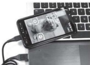
现在很多笔记本都支持USB关机充电功能，外出旅行时可以充当大号移动电源的角色。目前三星、戴尔、ThinkPad、方正、同方等品牌的很多新品均支持此功能，但类似功能都需要软硬件的配合才可以实现。以三星RF511笔记本为例，机身提供了四组USB接口，只有其中位于机身左侧边缘的USB接口才支持关机充电功能，其它接口是无法进行关机充电的。除了硬件的限制以外，还需要安装Chargeable USB和Easy Battery电源驱动（随机预装，但如果你重装过系统，可登录三星官网下载）。
