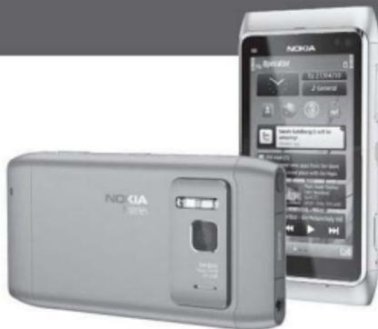
诺基亚N8内置的电池型号为BP-4D，容量为1250毫安时，但是这款手机的硬件非常强，有1200万像素的摄像头和与数码相机一样的氙气闪光灯，以及性能很高的多媒体和图形处理器。这些都是非常耗电的元件，所以N8的用户都会感到电量不够用。
