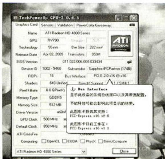
V1.1；在某个显卡性能要求较高的程序运行时自动转入V2.0。倘若将模式设置为“性能模式”，显卡将一直工作在PCI-E 2.0速率。以GTX480为例，在“自动模式”下待机温度大约是57度，但在“性能模式”下待机就是82度。
