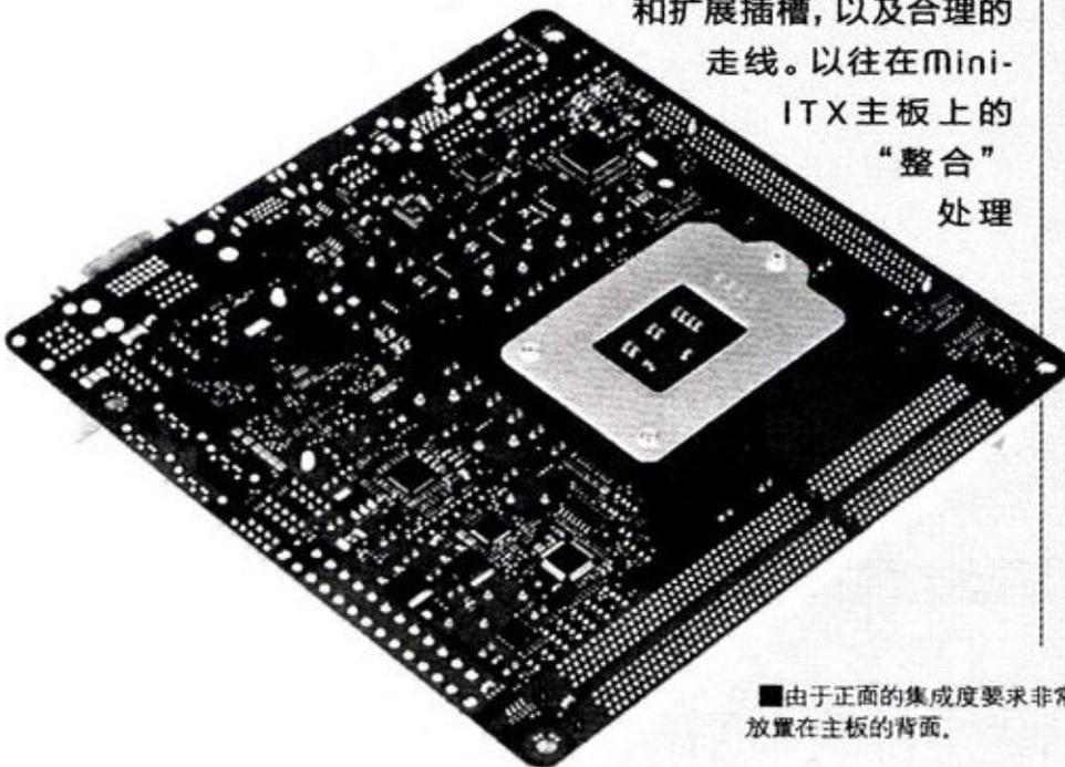
■由于正面的集成度要求非常高，所以这MiniITX主板的声卡、网卡以及频率发生器等芯片都常常被放置在主板的背面。
