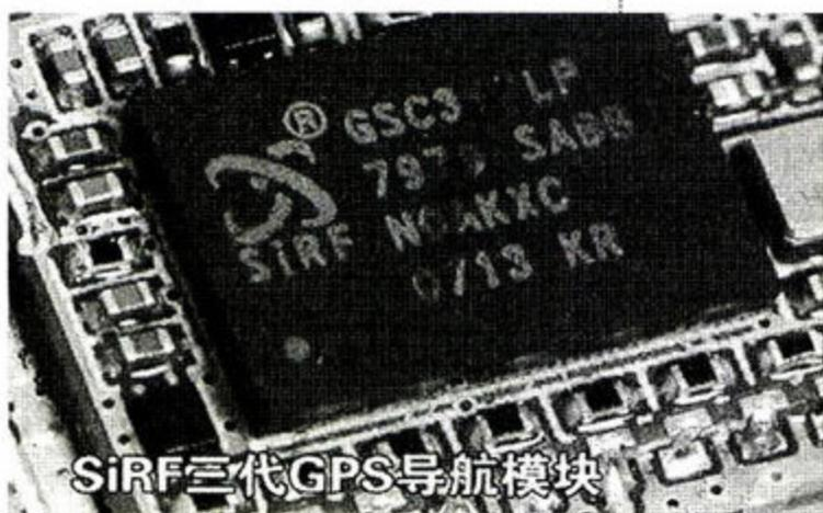
SiRF三代GPS导航模块
