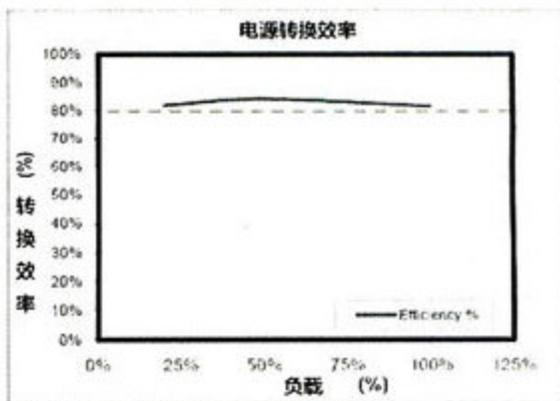
航嘉多核R80电源转换效率达到84%左右，搭配此套主流偏高端的配置仅211W的功耗难道不是你的最好选择吗？
