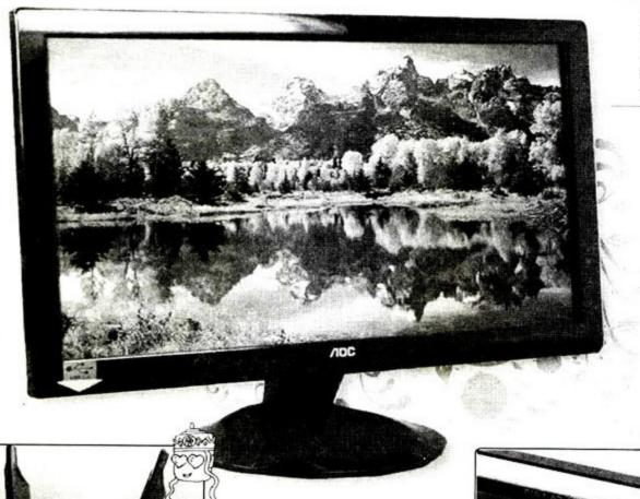
WLED背光液晶最早主打"薄型 化", 以超薄的机身为外观的主要卖 点,吸引消费者。超薄是WLED背光 的一个特点,但其最大的优势还在 于功耗的控制。
