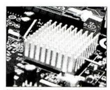
简单小巧的PCH散热器。可以看出Intel对 PCH的发热量比较有信心
