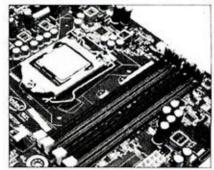
4条DIMM插槽, 配有独立供电
