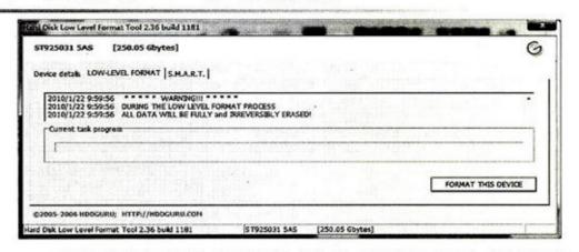
对面宿舍的小周过来帮忙检查,把笔记本硬盘拆了下来,告诉李群这个应该有办法解决。小周先将拆下来的笔记本硬盘装到一个移动硬盘 盒里,然后连接电脑,下载了低格软件Low Level Format (下载地址: http://tools.mydrivers.com/soft/424.htm),运行程序选中USB磁盘设备并按下"Continue (继续)"按钮,注意此时务必不能选错,如果点选了主硬盘,是无法有效进行操作的。
