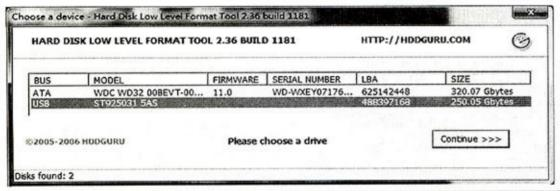
在新界面中,切换到 "Low Level Format (低级格式化)"一项,按下 "Format This Device (格式化该设备)",期间可能会出现大量 "Format Error Ocured at offset (格式化错误)"提示,不要理会,约30分钟后结束。把硬盘装回到李群的本本上,嘿,果然运行游戏不出事了,拷贝电影也没问题了,濒死的硬盘竟然这么一个简单的操作就原地满血复活了,真不赖! CF [YP04]
