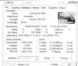
从规格编号中还能找到的一个规律是,处理器尾部编号分别代表了不同的意义,如Intel Core i7-620LM、Intel Core i7-620LM、Intel Core i7-620UM这三款吧,第一款尾号为M,代表Mobile,即移动处理器;LM的意思是Low Voltage低电压移动处理器;UM则是Ultra Low Voltage超低电压移动处理器的意思。这样你就能很容易辨别出看起来型号基本一致的处理器究竟有什么区别了。
