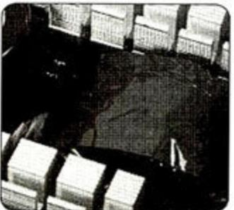
●PFC线圈的外侧同样缠绕了多层绝缘胶布,以保证线圈工作时不会对其他器件产生干扰。
