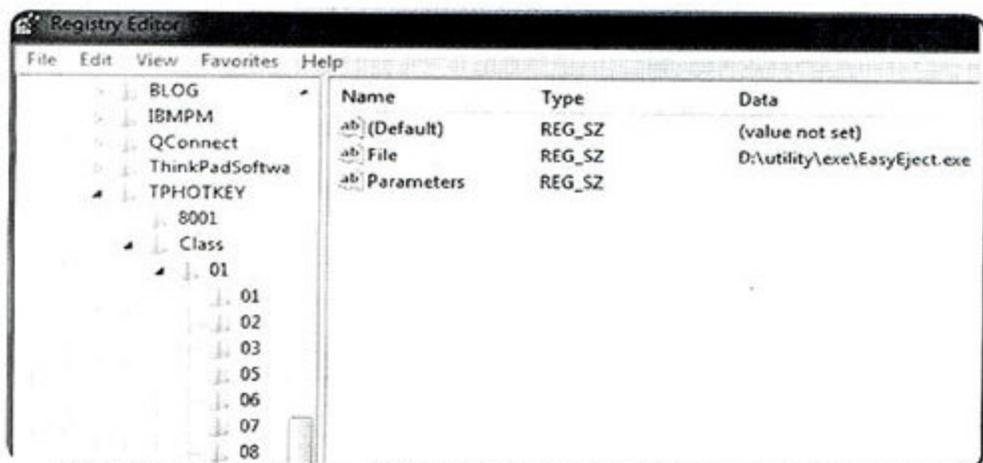
找到HKEY\_LOCAL\_MACHINE\SOFTWARE\Lenovo\TPHOTKEY\Class\01,这一项内01~0C是负责Fn+F1~F12功能键作用的。要修改Fn+F10,找到0A项,同第二步一样的方法,
