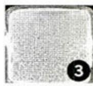
3),取下散热器观察CPU表面硅脂,如果均匀的呈波浪形,说明此时厚度最佳。CPU负载温度居然降下7度(见图4)
