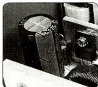
●由于主动PFC设计,所以这款电源使用了单颗100uF的高压滤波电容。
