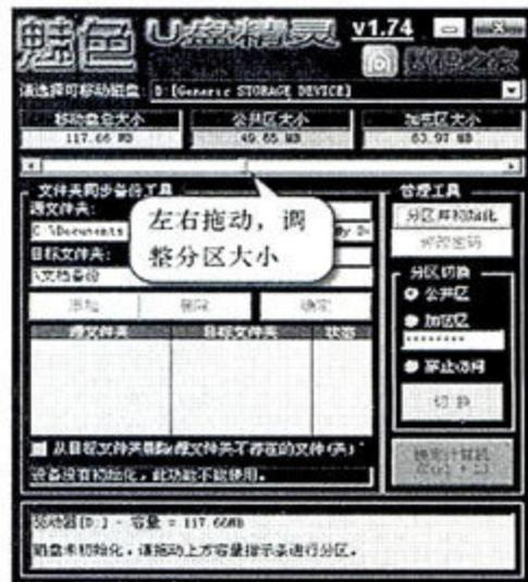
运行软件后（见图），将闪盘中的文件备份。通过拖动上方容量指示条调整分区大小。点“分区并初始化”。这里很简单，根据提示操作即可。分区完成后进入“我的电脑”，看下闪盘当前容量就会变小，对于已经执行过此操作的闪盘，“分区并初始化”按钮会变成“合并分区”。你可以将“公共区”容量设小些，这样即使别人借走也不会对你的闪盘感兴趣，因为容量太小，没法用啊。
