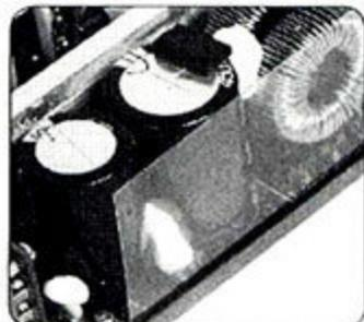
●主侧采用了日系Chemi-con电容，450V耐压值，电容容量分别为330uF和470uF。
