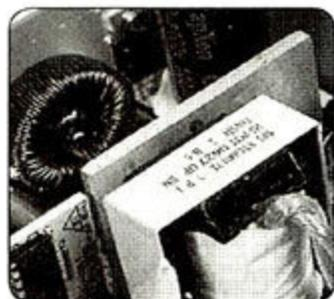
●正激式的开关变压器电路设计,其受电网波动更小,可靠性更高。
