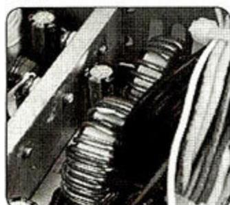
●低压滤波电容部分则使用了两个大号扼流线圈,保证了电流输出到硬件的电流纯度。
