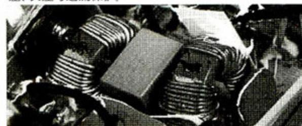
▲完整的两级EMI电路，可以有效减少电磁干扰与信号失真。
