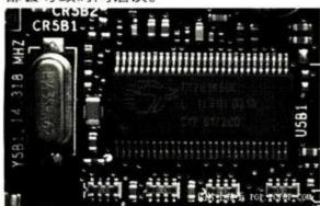
◆控制电脑时间的时钟电路由晶振、时钟发生芯片和一些辅助电阻、电容构成,使用纽扣电池来保存时间和系统设置信息。
