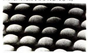
●电子显微镜下的CCD表面
