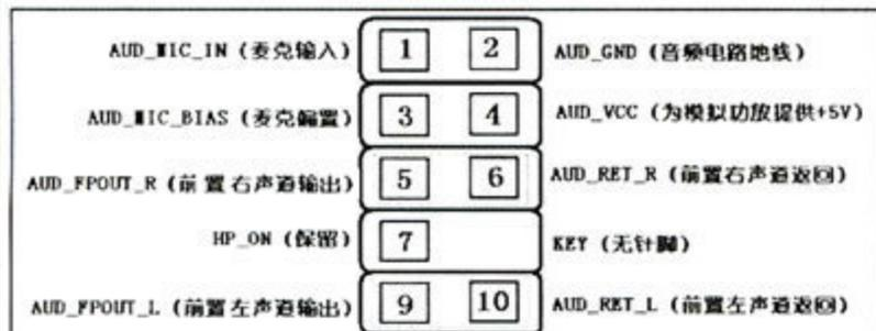
图为AC'97前置音频接口定义，在连接前置音频之前，主板的前置音频连接座的5和6、9和10针上面有跳线帽短接，连接前置音频线时需要取下，如果取下后不连接前置音频线，后置就没有音频信号输出。
