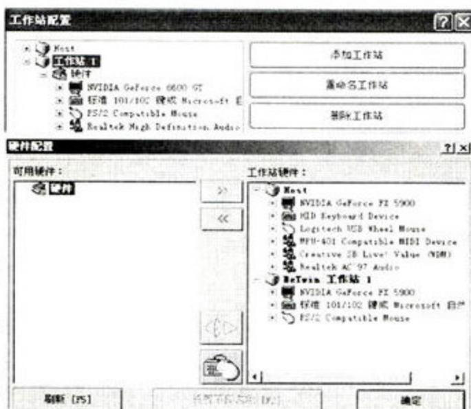
安装Buddy软件，安装结束后重新启动，点击“运行配置向导”，此时软件会分别在屏幕上提示确认操作（分别依据两个屏幕上的提示确认回车即可）。如果配置有问题，还可以启动手工模式，在软件主界面上点击“添加工作站”在“硬件配置”中，设置“副机”的使用设备，注意显示器、鼠标、键盘三个部分必须选择对应的外接设备，而不是本本自身的。再次启动电脑后，就可以在“副机”以用户buddy登录了。
