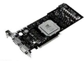
从实物图我们可以看到GeForce GTX285上最明显 的改进在于将16颗显存全部布线在PCB正面,而 GeforceGTX280则是平均分配在PCB的正反面,新设 计的好处在于简化布线。因此Geforce GTX285的PCB 只有10层板,而GeForce GTX280采用的P651 PCB是 14层PCB设计,用发烧友的话来说 "YY度" 有所降低。
