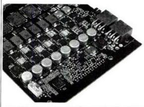
由于GTX285由于更新了制作工艺,对供电要求大幅降 低. 采用Intersil公司的供电芯片ISL6327. 为显示核心 提供4相供电. 显存2相, 大量陶瓷电容更换为普通固态 电容。更换供电模块和减少PCB层数后,使得GTX285 的成本大幅下降, 因此其价格将有不少下降空间。
