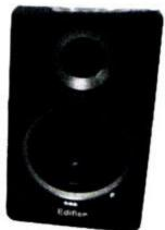
无线后置音箱非常合适。S20NT在外观方面与 漫步者S5.1的卫星音箱完全一致,采用3英寸中 低音单元玻纤编织复合纸盆,具有良好的刚性 和弹性,又不失柔和细腻的表现。而高音部分 则采用的是传统的1.0英寸丝膜高音单元,清晰 明亮,音质表现可圈可点,最大功率达到60瓦, 完全胜任作为后置音箱环绕声的要求。
