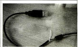
可以。将USB线缆预留出30cm的长度剪断,剥开线缆,找到其中+5V和GND两条线。例如我们选用的线取自坏鼠标,鼠标用USB线缆一般为白,绿、蓝、红(工业标准)。其中,蓝为GND、红为+5V。这两条线分别连接两个风扇的黑或黄线、即GND和红线、即+5V就可以了(其他USB线缆最好能用万用表测量一下)。最后,用黑胶带将线头处包裹好。如果怕不结实,最好用烙铁焊接一下线头。
