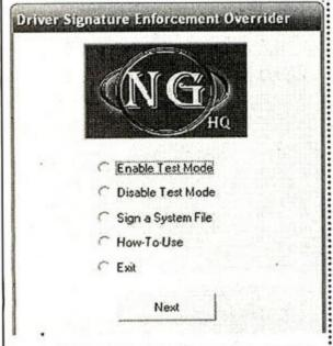
首先下载HIDUSBF和DSEO (http://www.myfiles.com.cn/ soft/21/21080.htm)。解压之后,先运 行DSEO1.2,选择"Enable Test Mode (测试模式)"。
