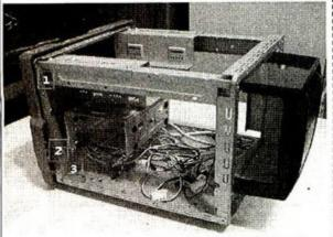
首先拆掉背面的三颗手转螺丝往后将机壳"抽"下来 接下来要将前面版拿下来, 这边要注意! 它总共有六个 卡口, 左右各三, 要从内部"扳开"才能将前面版拿下 来, 硬拔可能会将前面版弄坏的, 要小心!
