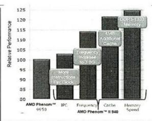
图中可以看出,由于核心架构的优化带来的提升仅有3%,可见羿龙II更多的改进在工艺带来的主频、三级缓存以及DDR 1333的支持,相较于羿龙X4 9550.采用DDR2 800内存的羿龙II 940性能的提升是20%左右,性能基本在酷睿2 Q9550和Q9450之间。
