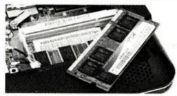
将内存以45度角斜插入内存插槽,注意对准那个"缺口",推到位后向下压内存,两侧的金属卡扣会"自动"卡住内存
