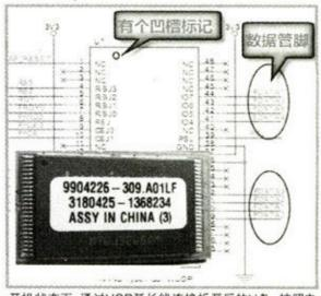
开机状态下, 通过USB延长线连接拆开后的U盘, 按照电 路图方位摆放好U盘(对准凹槽),然后用区别针联通两 个管脚(任意两个),注意不要连接第三个管脚,也不要 联通其他管脚。
