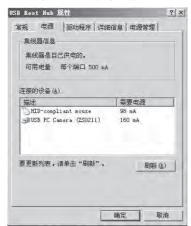
我们可以在Windows设备管理器中查看每个USB端口上设备所需要的电流大小,检查"USB Root Hub"(USB根集线器)属性中的"电源"选项卡,查看USB总线的功率消耗情况,如果是超出了主板的供电能力,就有可能出现小刘遇到的"电涌"情况。这时可以将暂时不使用的USB设备拔下。
