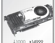
XFX讯暑8800GTX显卡采用P355公版的 设计, 支持全新的Shader Moder 4.0与 DirectX 10标准。 配备三星1.0ns GDDR3 显存颗粒, 12颗构成768MB/384bit的 顶级规格, 默认核心/显存工作频率高达 575MHz/1800MHz。散热方面采用NVIDIA 公版的大型涡轮风扇设计, 巨大散热片+ 热管的组合保证了良好的散热效果。
