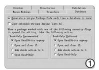
做完上边的操作后,再选择 "File  $\rightarrow$  Save As",将这个msi 文件 另存一下,然后在软件左侧的面板中 选择"Media",查 看右侧的"Cabinet" 列,你可以得到一个 后缀为cab的字段,例 如"#data.cab"(见 图 2 )。
