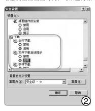
修改:在"Internet选项→安全→自定义级别"在"下载"栏各选项中全部选择"启用"(见图2)。然后切换至"高级"选项卡,在"安全"栏中取消对"检查下载的程序的签名"复选框的选中,选中"允许运行或安装软件,即使签名无效"复选框(见图3)。
