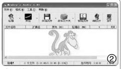
方法,但是对于WAV音频而言,无损压缩的话首选 Monkey's Audio (如图 2),它能够把WAV音频压缩成为 APE文件,而且是绝对无损的。在 http://ccl63.driversky.com/down/HA\_Mac40lb2\_chenmy.exe 下载 Monkey's Audio 回来,然后启动软件,把压缩模式调整到"疯狂"然后就可以压缩了。最后 4703744 字节的 WAV文件压缩之后得到 1175936,压缩比为 25%,至于另外 3 个文件采用 UHARC GUI 压缩,最后整个目录的大小为 8199647 字节,约为原本目录大小的 67%,这对于音频而言已经是相当了不起的数字了。
