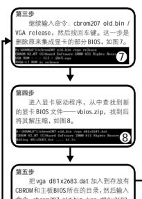
tr Vga d8 1 X2683. dat 加入到存放有CBROM和主板BIOS所在的目录,然后输入命令: cbrom207 old.bin /vga d81 x2683. dat,如图 9。这样就把新的显卡BIOS整合到了主板BIOS中了。我们可以利用之前的查看命令检查经过修改的主板BIOS,从中可以发现主板的BIOS中已经添加了新的显卡BIOS。
