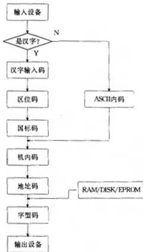
图二 各种代码变换流程
