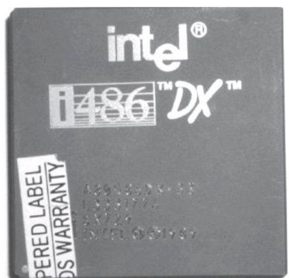
④ • 和袖珍电脑性能相当的英特尔80486处理器，通过1微米制造工艺，内部集成了120万个晶体管
