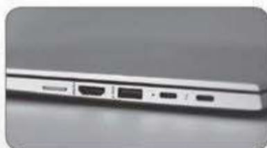
● 两个USB Type-C均支持雷电3功能
