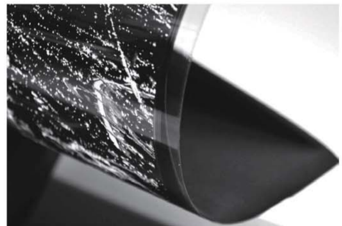
• LG展示的柔性OLED显示面板
