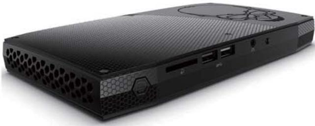
这款产品需要用户自行安装内存和硬盘，它提供了两个笔记本DDR4内存插槽以及两个M.2固态硬盘插槽，支持2280和2242两种规格的M.2固态硬盘。其他如USB接口、视频输出接口等配置都采用了较新的标准，数量也基本够用，扩展能力不错。
