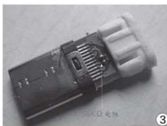
脚，以及额外的一颗电阻（图3），并没有什么技术含量。所以，4.9元和39.9元的转接头，用起来其实没有什么差别。
