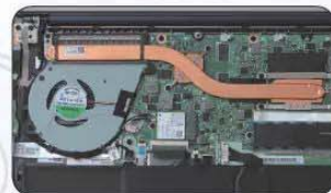
● U4100UQ的内部散热模块设计
