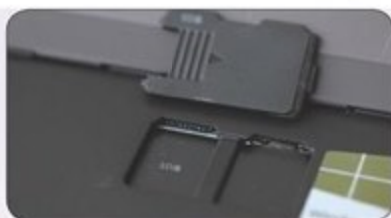
● 隐藏的读卡器和USIM卡槽
