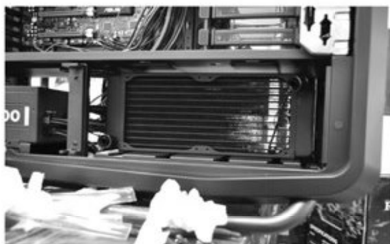
• 有的机箱冷排留有下置位置，方便安装
