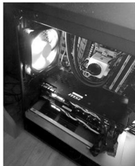
• 一体化水冷多数只有CPU散热方案，显卡方案较少
