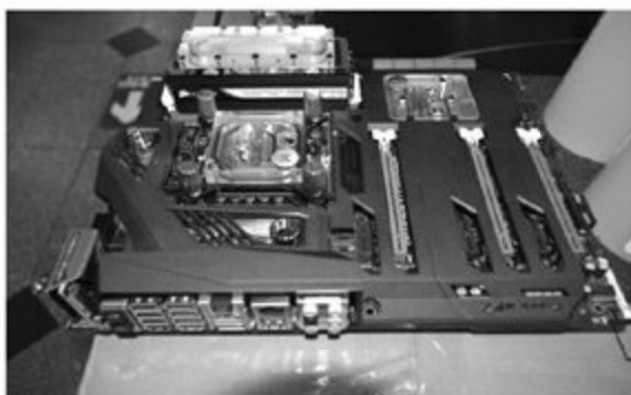
• 先安装好水冷冷头才行
