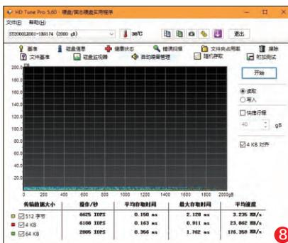
第一次运行和多次运行HD Tune Pro进行随机测试时的成绩截图，随机读取速度会在2次运行后出现爆发式增长
