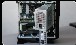
● 独特的PSU旋转臂设计
