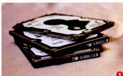
7mm、9.5mm和15mm标准的2.5英寸硬盘对比
