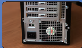
● 电源配有测试按钮与指示灯
