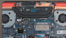
● 双风扇三热管的散热模块
