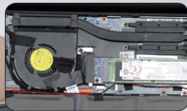
● XPS13的内部散热模块设计
