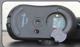
• 底部的配重仓设计以及10g的配置块
