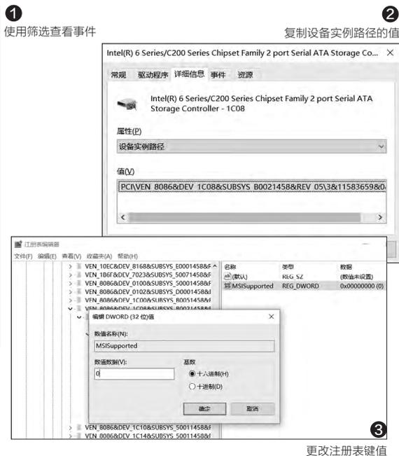
动记录该事件。因此如果你的系统有上述故障表现，请在系统搜索框输入“事件查看器”，启动事件查看器后展开“Windows日志→系统”，点击右侧窗格的“筛选查看器”，进行事件ID的搜索，看看自己的系统是否存在ID为129的事件，如果有，基本可以确定故障的原因就是MSI模式导致（图1）。
