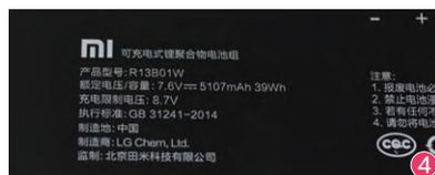
锂聚合物电池的形态和锂离子电池很像，也是一种扁平形态的能量体。只是，它将内部的电解质从液态换成了干状或胶状的固态物质(多为聚乙二醇或聚丙烯腈类)，而包裹它的外壳材料则多是铝塑软包装(图4)。在极端情况下，锂聚合物电池多以燃烧为主而不会出现爆炸，因此它的安全系列相对要好一些。
